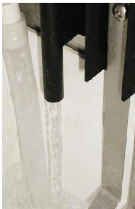
3. Вода поступает через клапан подачи воды, пока не наполнится бак, в котором
